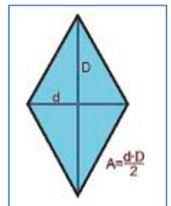
Otra manera de hallar el área de un rombo sería considerar que el rombo con sus dos diagonales forma cuatro triángulos rectángulos iguales de lados:  $15\text{ cm}$ , (la mitad de la diagonal  $D$ ),  $8\text{ cm}$  (la mitad de la diagonal  $d$ ), pues ambas diagonales se cruzan en el centro del rombo, y de hipotenusa  $17\text{ cm}$ , el lado del rombo.
